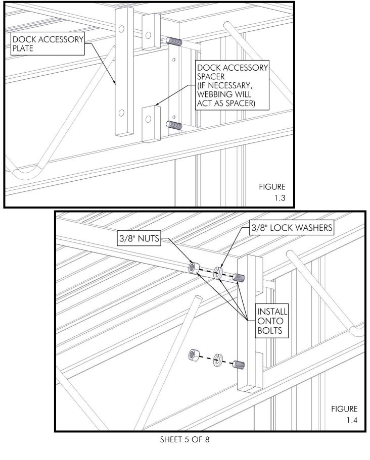
TORQUE NUTS TO 30 FT-LB AND ENSURE BUMPER IS SQUARE TO THE TOP OF THE DOCK (FIGURE 1.5).
