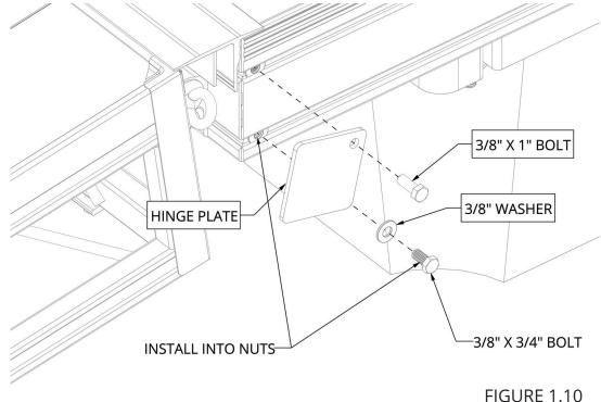
POSITION THE HINGE PLATE OVER THE END OF THE HINGE PIN AND TIGHTEN BOLTS TO 10 FT-LB (FIGURE 1.11).
