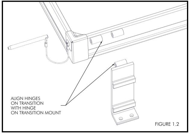
RE-INSERT THE PINS ON THE TRANSITION INTO THE HINGES ON THE TRANSITION AND HINGES ON THE MOUNT (FIGURE 1.3). POSITION THE TRANSITION WITH MOUNTS ONTO THE END OF THE DOCK WHILE ENSURING THAT THE SIDE OF THE TRANSITION IS FLUSH WITH THE SIDE OF THE DOCK
