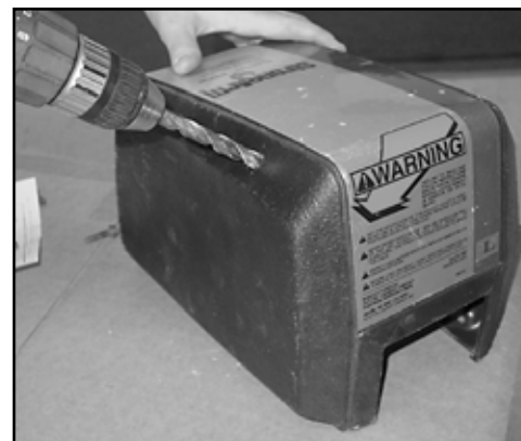
Fig. 6 Drill hole for grommet.
