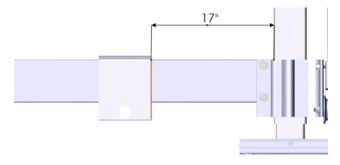
SLIDE SPINDLE ASSEMBLY INTO FEMALE CLAMP ON INTERIOR OF LIFT AS SHOWN. PLACE A SPACER ON THE INSIDE SPINDLE.
