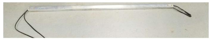
WRAP ELECTRICAL TAPE AROUND BOTH CONNECTORS TO EACH SOLAR PANEL. TAPE SHOULD WRAP PAST PLUGS APPROXIMATELY ONE INCH.
